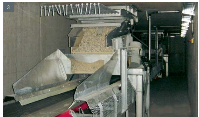
2. Aufgaberinne Typ ARLU / Vibrating Feeder Type ARLU ■ 3. Förderrinne Typ FRLM / Vibrating Feeder Type FRLM
